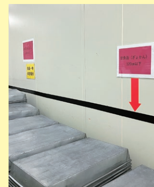
荷崩れ防止対策として積み上げルールを可視化
