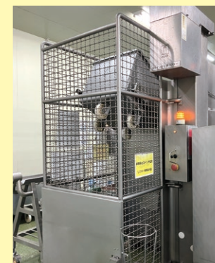
機器周りに安全柵を設置し稼働エリアに侵入出来ない仕組み
