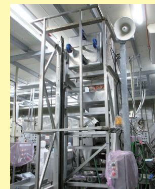
機器周りに安全柵を設置し稼働エリアに侵入出来ない仕組み
